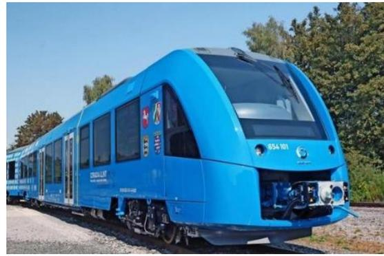
Brennstoffzellen-Zug in Bremervörde<sup>15</sup>
