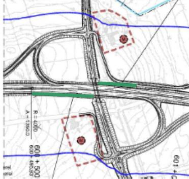
Im Zuge der A 20 geplanter Lärmschutzwall bei Kiel bei der Höhe
